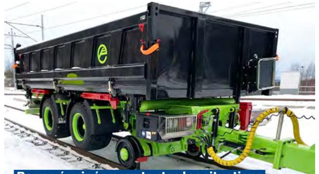
**Benne équipée pour toutes les situations avec volets latéraux et trappes hydrauliques**
