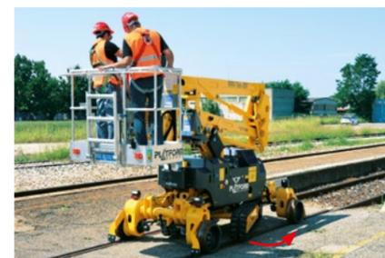
Raupenfahrwerks als auch für die Kraftübertragung auf das Schienenrad. Jedes motorisierte Schienenrad hat eine negative Bremse, um das Anhalten der Ausrüstung in jedem Zustand ohne Antriebskraft zu gewährleisten. Zusammen ermöglicht ein Zwei-Gang-System den Einsatz von RR9/200 bis zu einer Geschwindigkeit auf Schienen von 10km/h.
