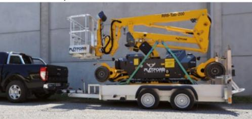
Die Struktur des RR9 / 200 besteht aus einem Grundrahmen, der auf Raupen für den Straßen- und Offroad-Einsatz ausgelegt ist und bei allen Bodenverhältnissen eine hervorragende Bodenhaftung bietet, zusammen mit einer geringen spezifischen Last, die speziell dafür ausgelegt ist, auch die Bewegung auf gepflasterten Bahnsteigen von Bahnhöfen zu ermöglichen.
