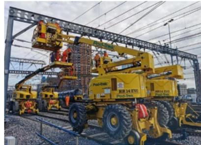
Unabhängiges hydraulisches Traktionssystem auf Straße und Schiene, um den Einsatz der Maschine einfacher und funktioneller zu gestalten. Erhältlich mit austauschbaren Schmalspurschienenachse
