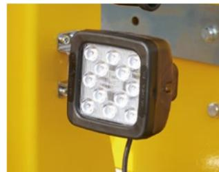
Große Auswahl an Arbeitsscheinwerfern, die an verschiedenen Stellen der Arbeitsbühne installiert sind, um die Maschine nachts problemlos bedienen zu können.
