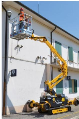
Die kleine RR9/200 ist mit Raupenantrieb ausgestattet, die eine bessere Zufahrt auf der Schiene und eine geringere Bodenbelastung ermöglicht, besonders interessant auch für den Einsatz am Bahnkai.
