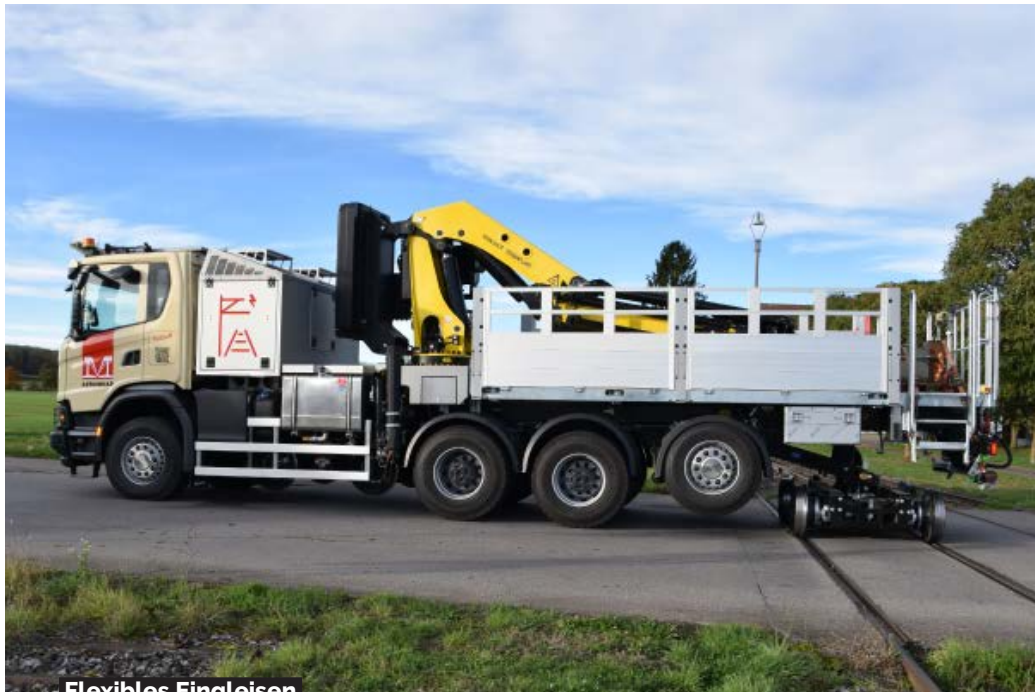
Eingleisstelle: min. 8.5m Anschlussbereich Strasse, möglichst eben
