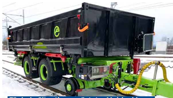
Für jede Situation gerüsteter Muldenkipper mit Seitenläden und hydraulischen Klappen
