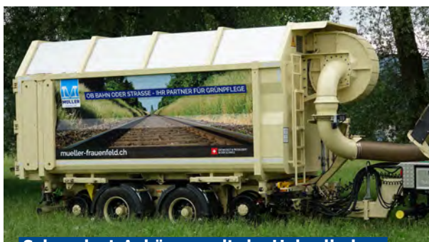
Schwerlast-Anhänger mit vier Hubzylindern für einen schnellen Wechsel der Aufbauten
