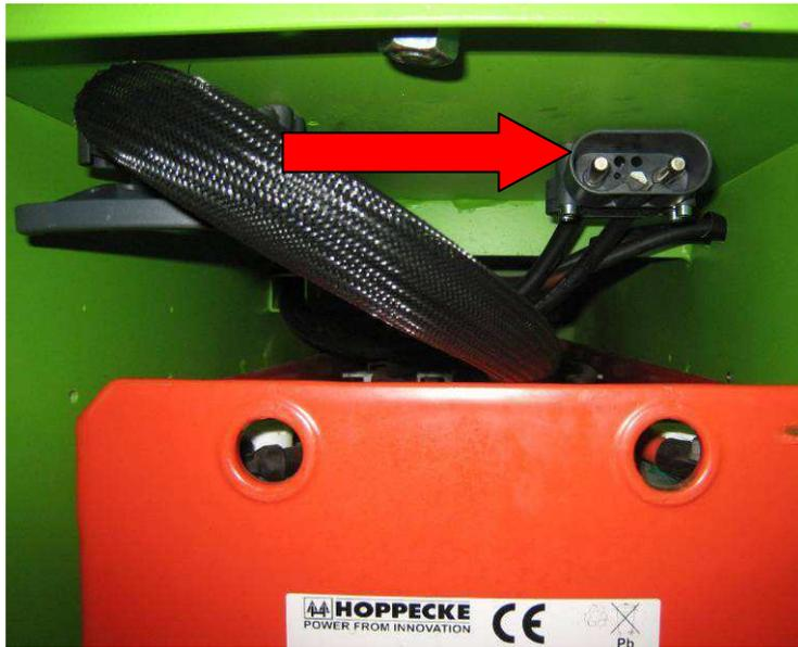
Anschließend auf der anderen Seite des Gerätes mit der Stromzuführung beginnen.
