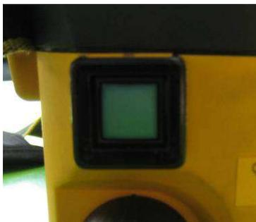
Ein Blinken der LED-Anzeige an der Fernbedienung bedeutet, dass der Sender aktiv ist. Ein Blinken der Betriebszustandsleuchte am Fahrzeug bedeutet, dass das Fahrzeug betriebsbereit ist.
