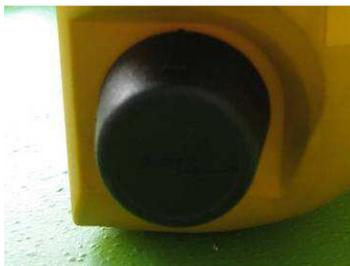
Nach dem Ertönen zweier Pfeifsignale (Systemüberprüfung) ist der am ROTRAC E2 vorhandene Schlüsselschalter einzuschalten (nach rechts drehen).
