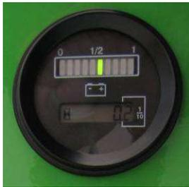
Die Batterie hält erfahrungsgemäß ca. 8 Betriebsstunden. Daher bitte nach dem Einsatz die Batterie über Nacht laden.
