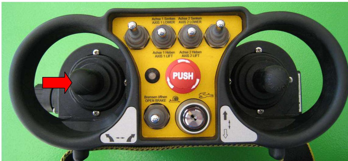
Die Fahrgeschwindigkeit kann über den Schlüsselschalter „Geschwindigkeitsregler“ vorgewählt werden. Der Schlüsselschalter ist in der reduzierten Fahrgeschwindigkeit abziehbar – empfehlenswert bei Rangiereinsatz.
