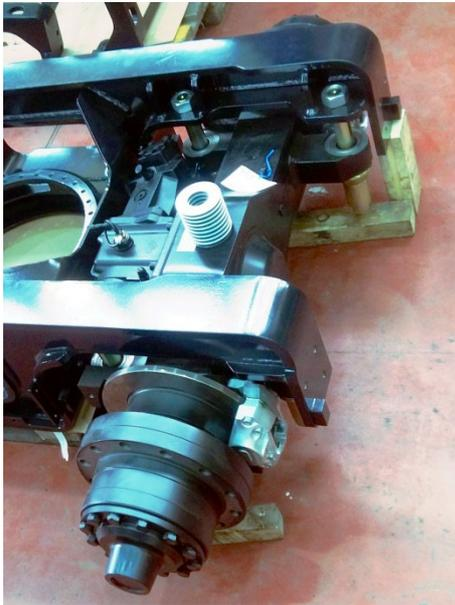
Abb. 4: Montage der Schienenachse
