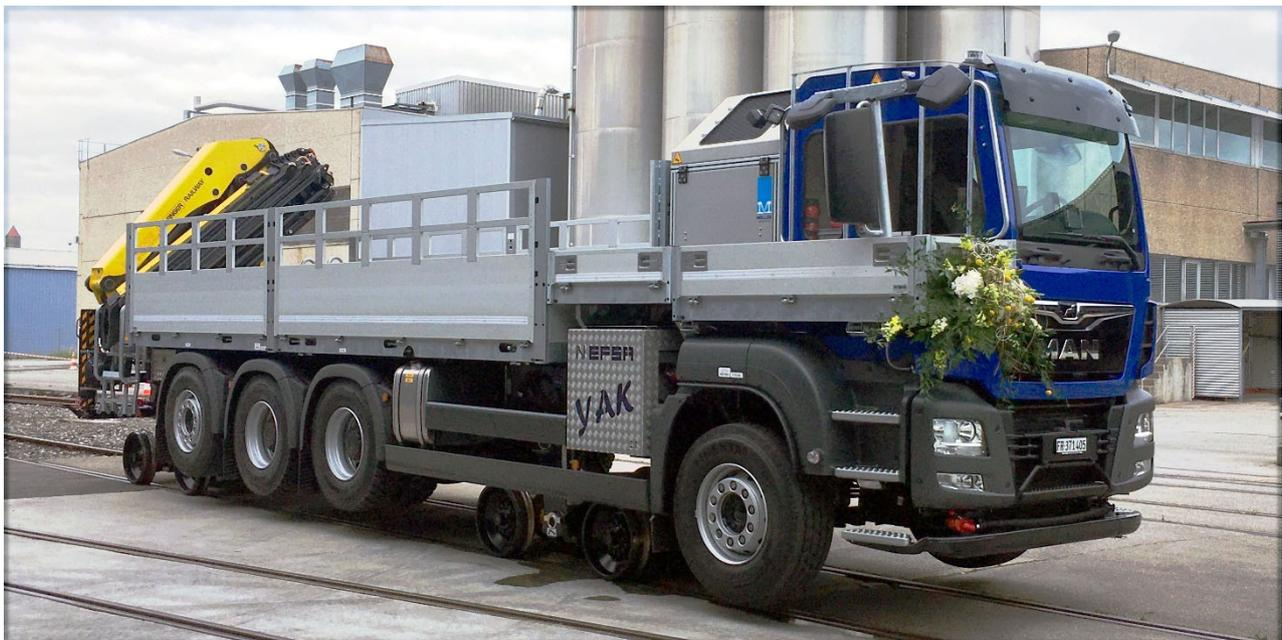
Abb. 21: Zweiwege-LKW mit Ladebrücke und Heckkran (YAK)
