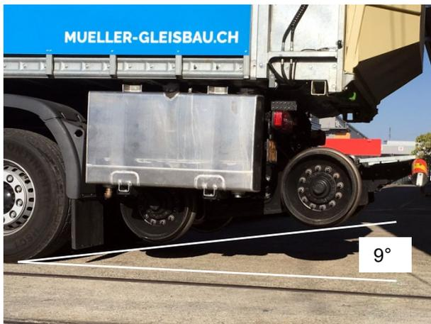
Abb. 9: Böschungswinkel hinten
