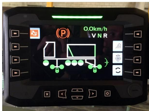
Abb. 18: Display Zustandsanzeige Zweiwegeeinrichtung
