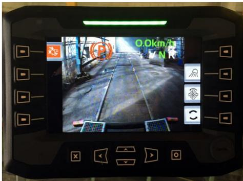
Abb. 14: Display Bild Rückfahrkamera
