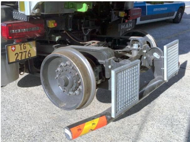
Abb. 11: Unterfahrerschutz bei Strassenfahrt
