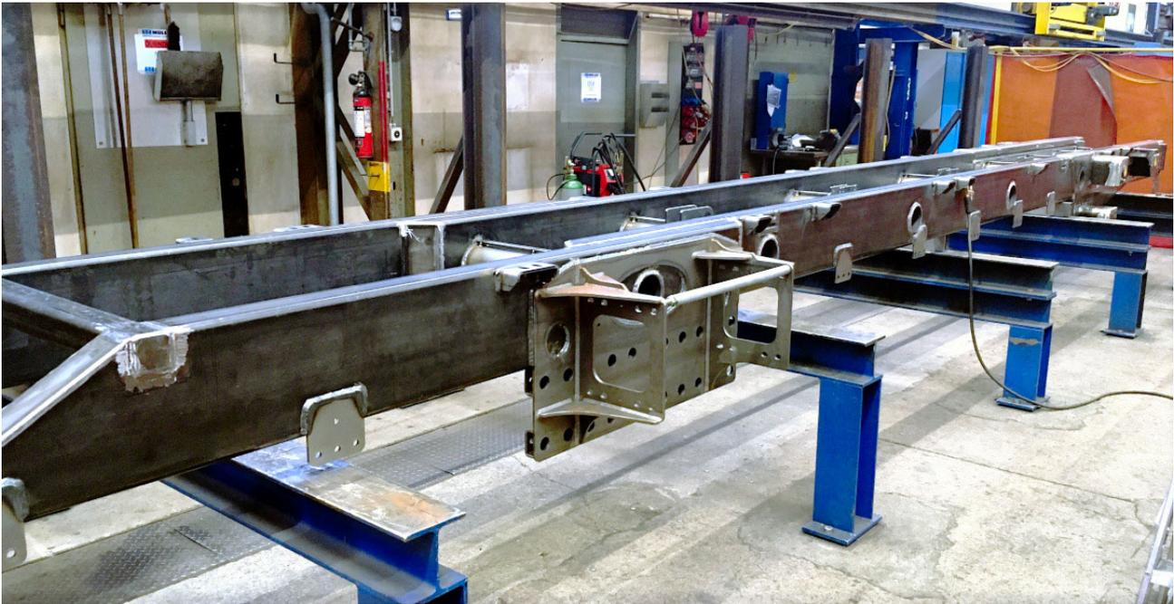
*Abb. 2: Rohbau Aufbaurahmen*
