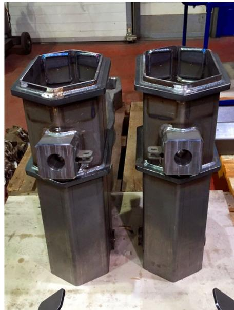
Abb. 7: Teleskop-Aussenrohre im Rohbau
