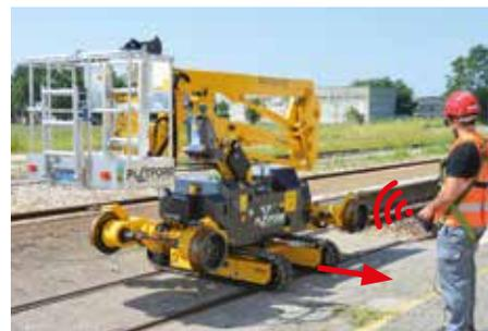
Das Fahren der Maschine kann durch eine an Bord des Korbes angebrachte Fernsteuerungseinheit oder durch den Bediener am Boden ohne Last im Korb betrieben werden.
