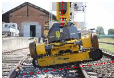
**Die Leistungsausgabe** erfolgt über einen endothermen 10,5-kW-Dieselmotor. Auf Anfrage kann die Maschine auch mit Lithium-Ionen-Batterien für den vollelektrischen Betrieb ausgerüstet werden, um die Ausrüstung für den Einsatz in Tunneln, U-Bahnen und im Innenbereich von Gebäuden wie Hangars, Bahnhöfen etc. zu optimieren.
