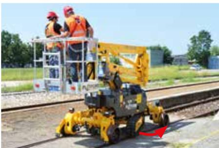
Die um 90 Grad schwenkbaren Raupen ermöglichen ein einfaches und schnelles Einführen auf dem Gleis und das Verlassen desselben.
