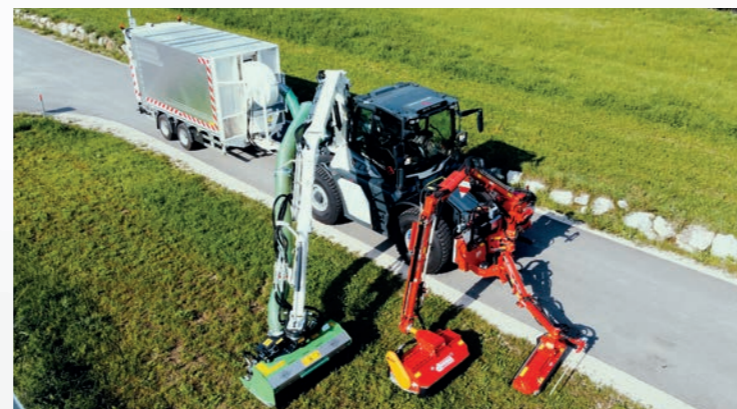
Un seul attelage SYN TRAC au lieu de trois véhicules spéciaux : le maniement aisé des deux agrégats par une seule personne permet de tailler les haies simultanément à la verticale et à l'horizontale, en incluant l'aspiration de l'herbe coupée.
