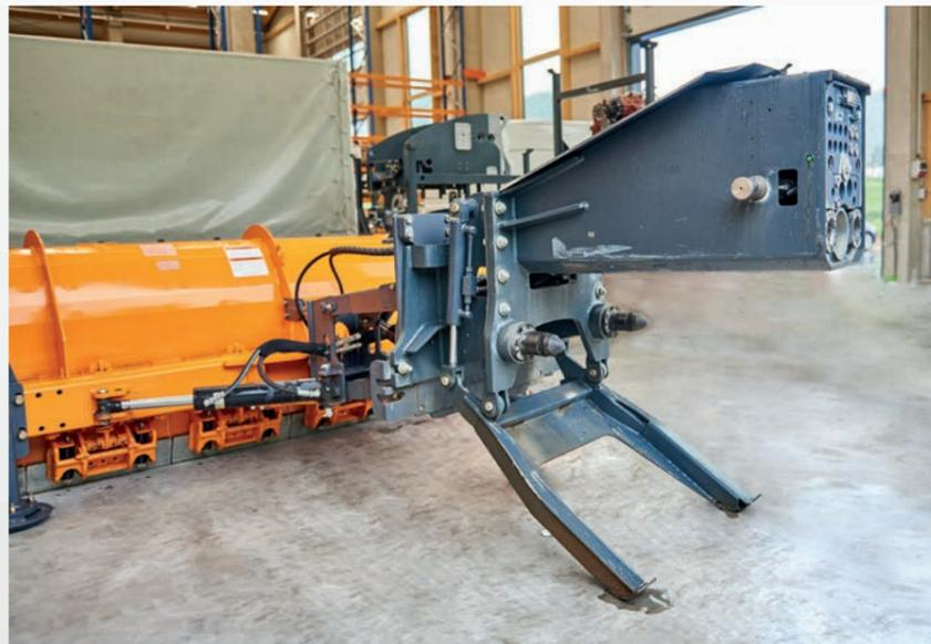
Sieben Verbindungsbereiche werden in unter einer Minute automatisch verbunden – mit nur einem Mann, der dazu die Fahrerkabine nicht verlassen muss.
