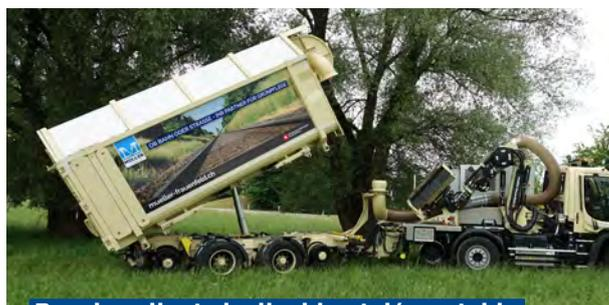
**Bac de collecte inclinable et démontable d'une capacité de 28 m<sup>3</sup>**
