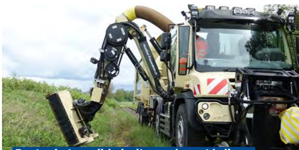
**Poste de travail à droite agrémenté d'une porte spéciale pour une vue optimale**
