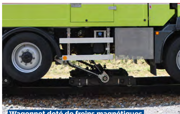
Wagonnet doté de freins magnétiques pour rails
