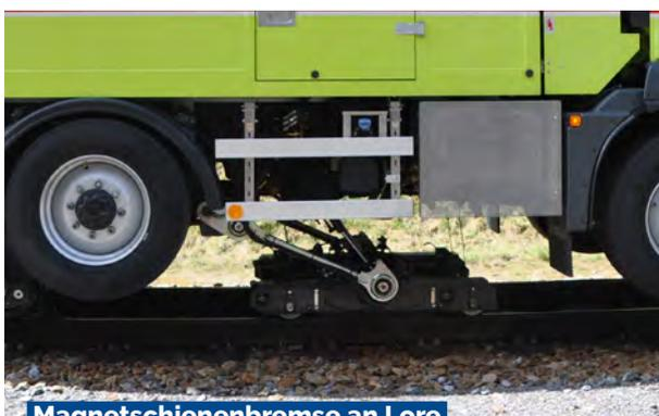
**Magnetschienenbremse an Lore**
