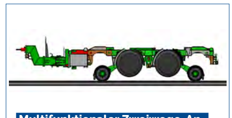
Multifunktionaler Zweiwege-Anhänger mit 3-Seitenkipper Nutzlast: 13.5 t / Gleis 19.5 t
