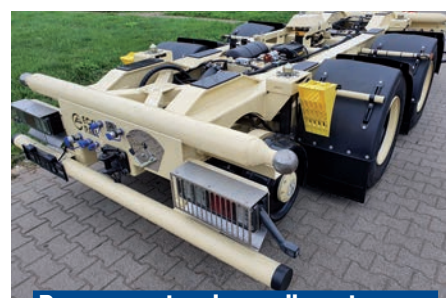
Remorque tandem rail-route avec système de changement de structure Twistlock 10 ou 20 pieds
